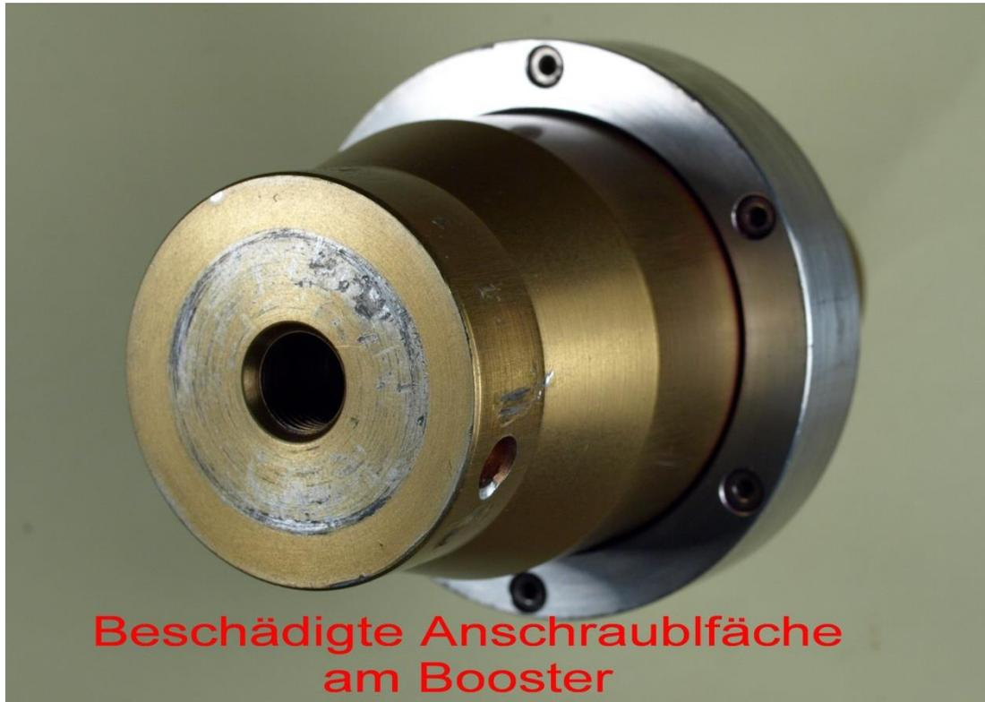
An der Anschraubstelle Sonotrode Booster entsteht durch die geringe radiale Bewegung an der Fläche Kontaktkorrosion. Beim Abschrauben der Sonotrode wird dann die Fläche beschädigt. Diese Kontaktkorrosion lässt sich vermeiden, wenn zwei Scheiben aus Polyesterfolie ca. 0,02 mm dick beigelegt werden. Zu beachten ist: durch die geringere Reibung zwischen den zwei Polyesterfolienscheiben beim Anziehen, wird bei gleichen Anzugsmoment eine höhere Anzugskraft, eine höhere Flächenpressung erreicht.
